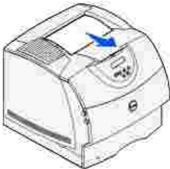
Si no se puede extraer fácilmente, deje de tirar. Abra la puerta frontal superior y extraiga el material de impresión.
