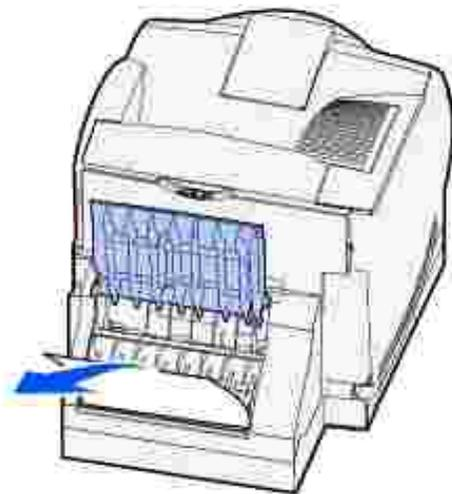
Empuje hacia abajo y tire del material de impresión hacia fuera si ese encuentra en esta posición.
