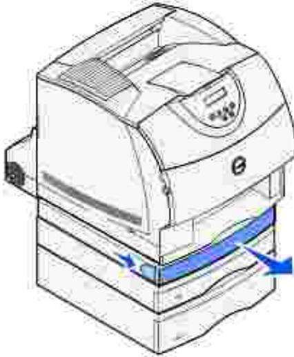
3. Si la parte visible del material de impresión es el borde, tire de él hacia arriba para extraerlo.
