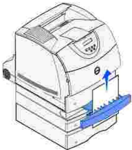
Si no puede ver el material de impresión, continúe con el [paso 10](#). De lo contrario, cierre la cubierta de acceso frontal del dúplex.
