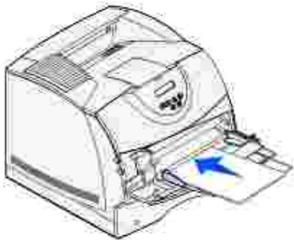
3. Deslice hacia la izquierda la guía de anchura hasta que toque ligeramente la pila del material de impresión. *No* doble el material de impresión.
