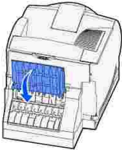
7. Presione el pestillo 1 para abrir la puerta inferior. Presione el pestillo 2 para abrir la puerta superior.
