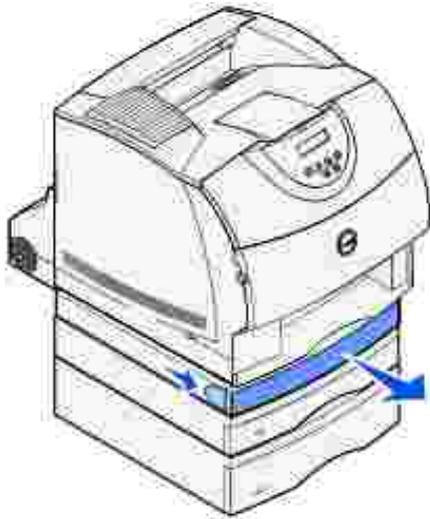
9. Si la parte visible del material de impresión es el borde, tire de él hacia arriba para extraerlo.
