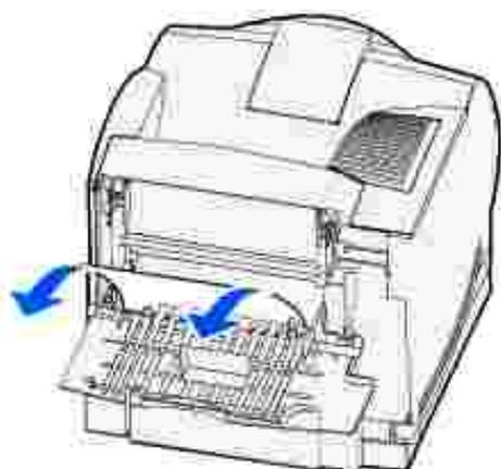
Si no se puede extraer fácilmente, deje de tirar. Extraiga el cartucho de tóner y, a continuación, tire del material hacia fuera.
